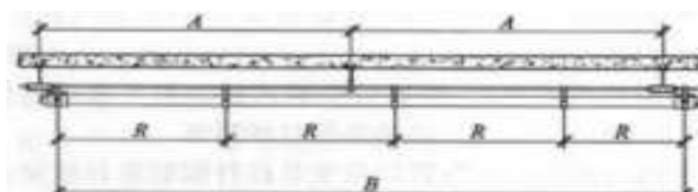
图 5.4.7-1 DN40~DN315 的 HDPE 管悬吊管管卡布置
